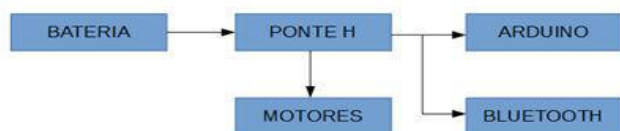
Figura 1. Sistema de potência elétrica
