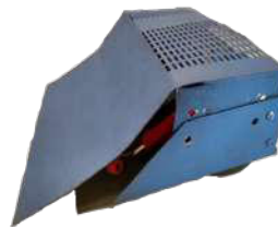
Figura 7. Protótipo de robô sumô desenvolvido vista superior.
