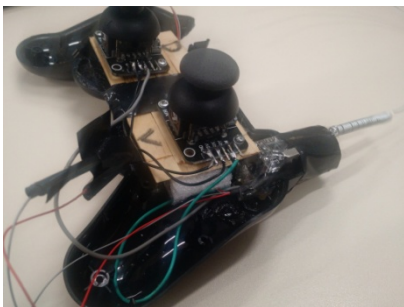
Figura 2. Eletrônica do transmissor.
