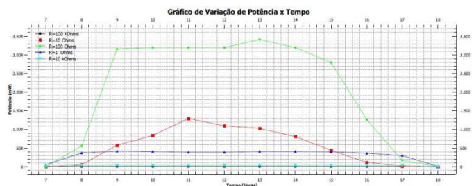
Figura 2. Gráfico Potência x Tempo obtido da análise do painel fotovoltaico.
