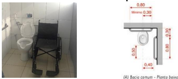
Figura 1: Banheiro acessível/ Figura 2: Dimensionamento das barras de apoio
