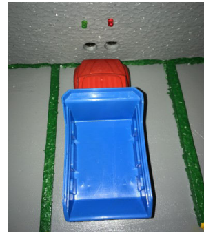
Figura 2. Carrinho ocupando vaga e ativando o LED vermelho, consequentemente desativando o verde.
