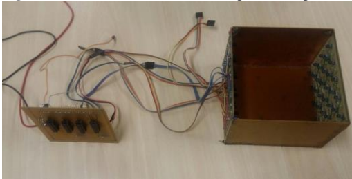
Figura 3. Elemento sensor conectada a placa multiplexadora
