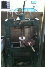
Figura 5. Prensa para moldagem dos corpos de prova.
