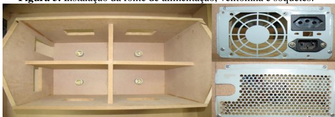
Figura 5. Instalação da fonte de alimentação, ventoinha e soquetes.
