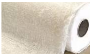
Figura 3: Rolo com manta de fibra de vidro
