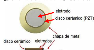
Figura 2. Estrutura do diafragma piezelétrico.
